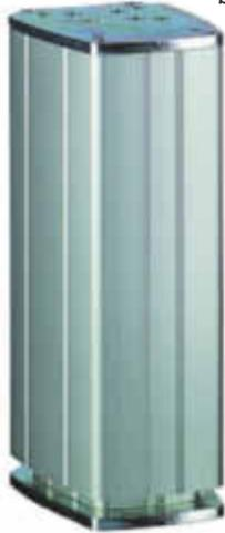
Hubsäulen bestehen aus eloxierten Aluminium-Strangpressprofilen, die sich beim Einfahren ineinanderschieben. Diese Konstruktionsform erlaubt besonders hohe Momentbelastbarkeit bei unvermindert hoher Verstellgeschwindigkeit. Laut Hersteller ist die Hubkraft im Verhältnis zur Einbaugröße extrem hoch. Zudem eröffnet die Möglichkeit, mehrere Einheiten miteinander zu koppeln, Konstrukteuren bei der Planung eine hohe Flexibilität. Thomson Industries, Wolfschlugen, Tel. (07022) 504-0
