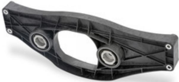
Der Lagerungsspezialist ContiTech hat erstmals einen Getriebequerträger aus dem glasfaserverstärktem Polyamid *BASF Ultramid* für die Hinterachse entwickelt, der in der *S-Klasse von Mercedes-Benz* eingesetzt wird. Im Vergleich zu Ausführungen aus Aluminiumdruckguss ist die neue Variante rund *25 Prozent leichter*.
